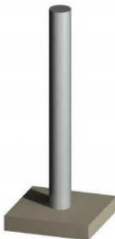
Croqui esquemático em 3D do suporte metálico móvel para placa de sinalização
